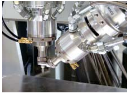
»3 Der zweite Mischkopf, der für die Zumischung der Elastomerhaut zuständig ist, kann einfach angeflanscht werden
