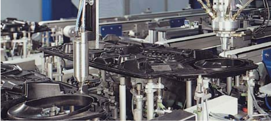
Bild 5: Vorbehandlung mit Plasma für eine bessere Haftung der Dichtung auf Kunststoffen
