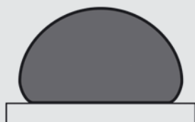
Bild 1: Kompakte Dichtungen, FIPFG – Nicht geschäumte in-situ Dichtungen entstehen durch Polymerisation ohne Volumenänderung
