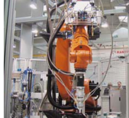
Bild 4: Auftrag auf steilen oder stark geneigten Auftragsflächen
